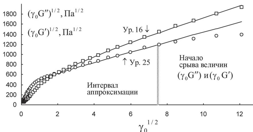
Рис. 2. Зависимость амплитудного модуля потерь (квадраты) и амплитудного модуля накопления (кружки) от амплитуды деформации  $\gamma_0$  (%) при частоте  $\omega = 0,63$  рад/с в корневых координатах для расплава композита L389-f при температуре 130 °С
