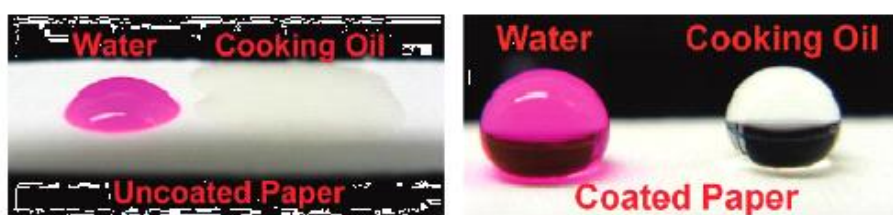
Рисунок II.4.6 Изображение капель растительного масла и воды на поверхности бумаги без обработки (слева) и с обработкой полимером PFOEMA (справа) [244]
