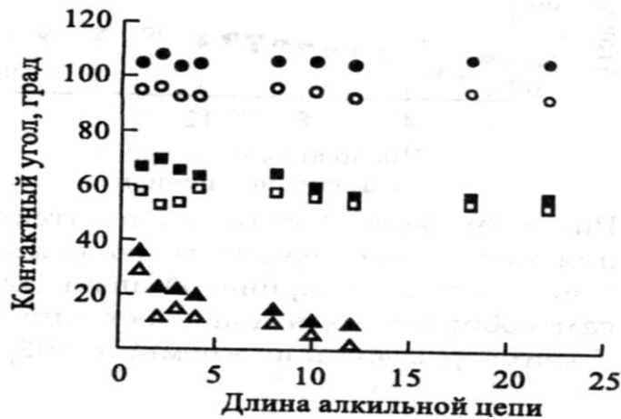
Рисунок II.3.2 Зависимости углов смачивания воды (кружки), иодистого метилена (квадраты) и гексадекана (треугольники) от длины алкильной цепи для ковалентно - привитых монослоев алкилдиметилхлорсиланов на кремнии. Темные значки – углы натекания, светлые – углы оттекания [140]
