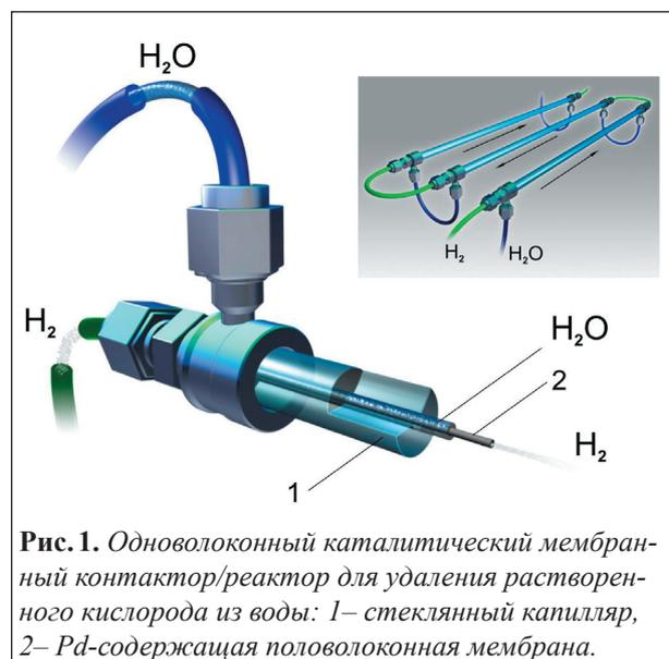
**Рис. 1.** Одноволоконный каталитический мембранный контактор/реактор для удаления растворенного кислорода из воды: 1 – стеклянный капилляр, 2 – Pd-содержащая полволоконная мембрана.
