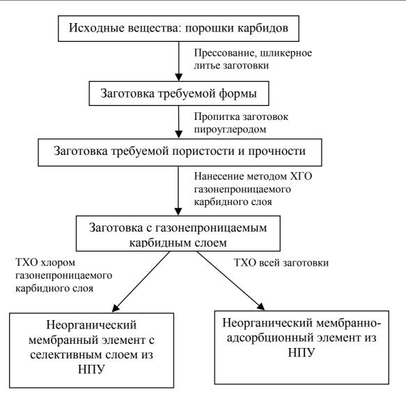
**Рис. 8**. Принципиальная схема получения неорганических карбидных мембранных элементов с селективным слоем из НПУ и неорганических мембранно-адсорбционных элементов из НПУ
