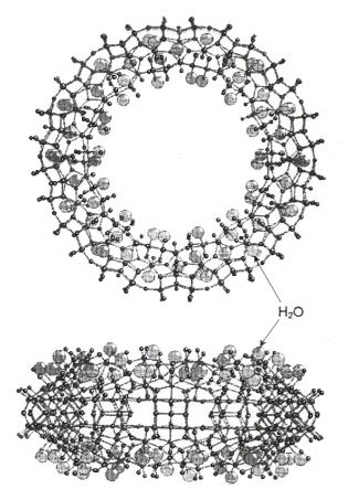
**Рис. 2.** Структура молибденового синего в виде гигантского кластера типа  $\{Mo_{154}\}$  с 70  $H_2O$  в качестве лигандов, в котором содержатся атомы молибдена разной валентности  $[Mo^{VI}_{126}Mo^{V}_{28}O_{462}H_{14}(H_2O)_{70}]^{14-}$
