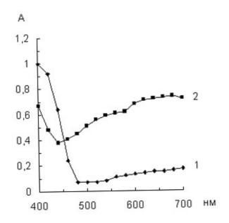
**Рис. 4.** Спектры поглощения: 1 – полосы  $30 \times 16$  мм РИБ для мембран, 2 – той же полосы, восстановленной ДМГ до образования темно-синей окраски. Спектрофотометр КФК-3. Стеклянная кювета толщиной 1 мм
