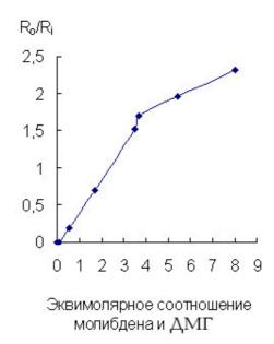
**Рис. 5.** Зависимость значения  $R_o/R_i$  коэффициентов диффузного отражения ИЗ диаметром 6 мм на мембране диаметром 10 мм ( $R_o$ ) и ее продукта с ДМГ ( $R_i$ ) от эквимолярного отношения Мо и ДМГ; исходная концентрация ДМГ 2 мг/л, проба 10 мл. Рефлектометр-колориметр МУЛЬТИЭКОТЕСТ. Светодиод красный с максимумом излучения при 660 нм
