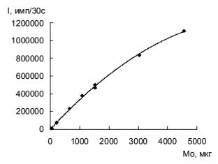
**Рис. 3.** Градуировочный график по определению молибдена РФЛА в мембране диаметром 24 мм
