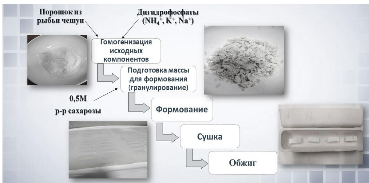
**Рис. 1.** Схема получения образцов керамики.
