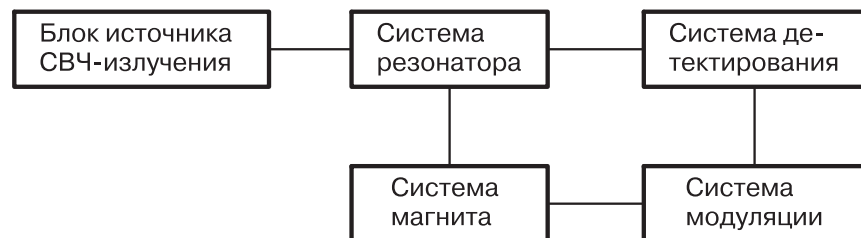
Рис. 3.33. Блок-схема радиоспектрометра ЭПР X-диапазона
