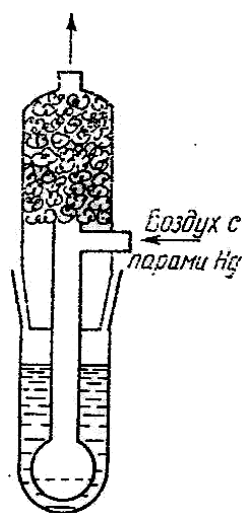
Рисунок 1.21 - Схема аэратора - барботера
