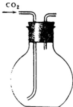
Рис. 1. Платиновая колбочка для определения закисного железа
