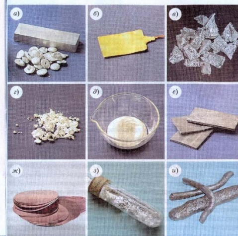
Рис. 51. Простые вещества — металлы: а — алюминий; б — золото; в — цинк; г — серебро; д — ртуть; е — свинец; ж — медь; з — натрий; и — осмий
