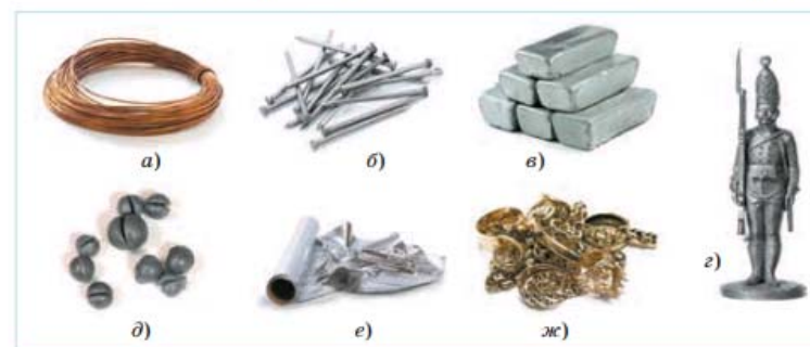
Рис. 121. Некоторые металлы и сплавы: а — медь; б — сталь (сплав на основе железа); в — цинк; г — олово; д — свинец; е — алюминий; ж — ювелирное золото (сплав золота с медью)
